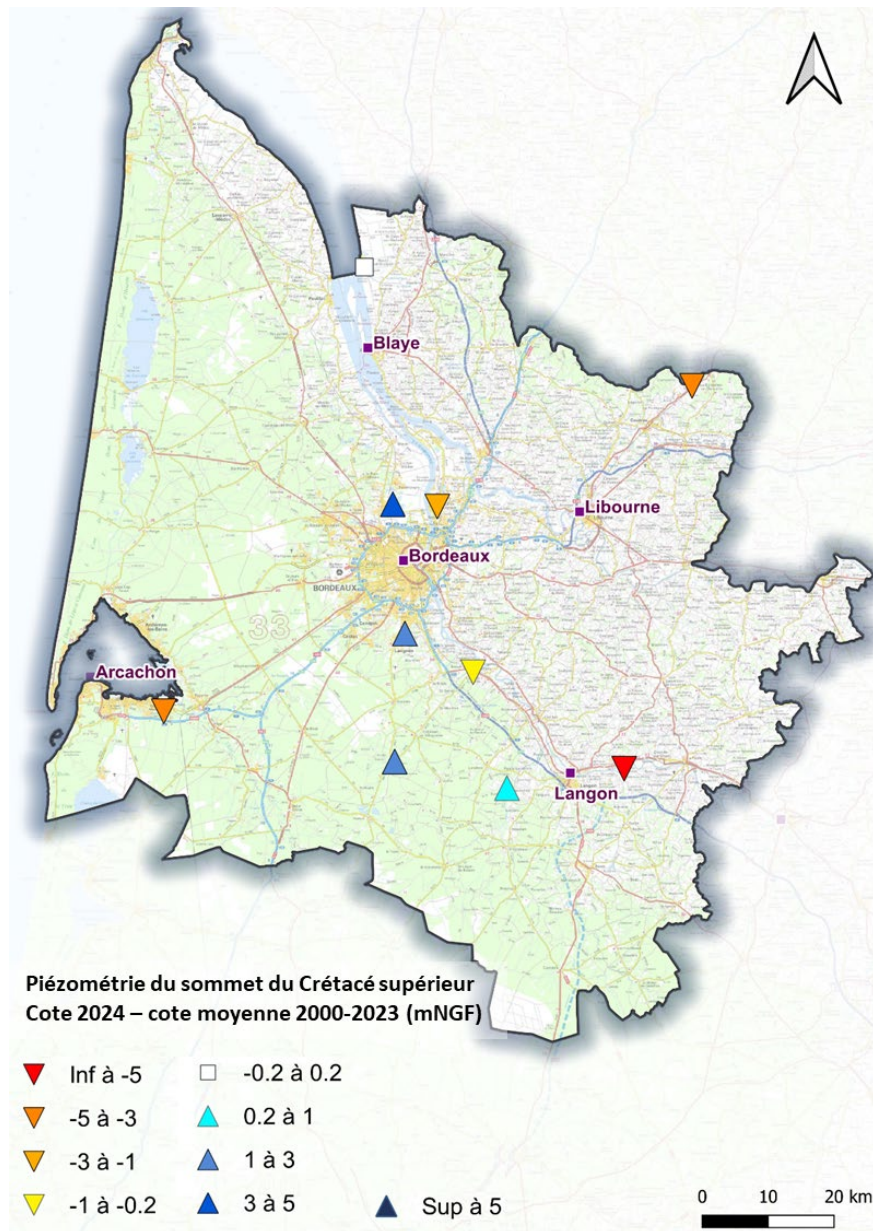
Illustration 21 - Comparaison de la piézométrie pour la nappe du sommet du Crétacé supérieur entre 2024 et la cote moyenne 2000-2023
