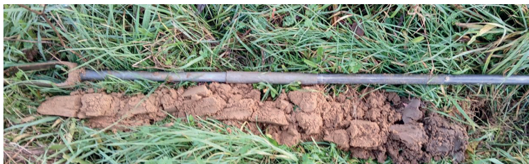
Exemple de carottage pour réaliser le diagnostic stationnel
