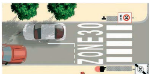
Le marquage en entrée de zone 30
