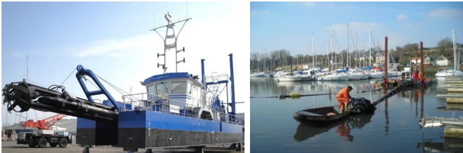
Exemples de drague aspiratrice stationnaire et d'une conduite de refoulement des sédiments
